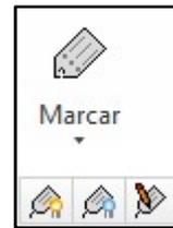
**Nomear em lote:** Adiciona marcas a várias peças em lote, podendo o usuário definir um prefixo para o nome e o programa irá adicionando um contador conforme configurado na janela do comando. (Comando: "ANC").
