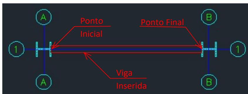
Vista de nível com a viga inserida
