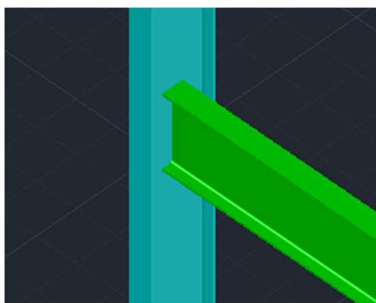
Viga com eixo de inserção coincidente com centro geométrico
