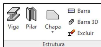
**Viga:** Abre a caixa de diálogo para a configuração e inserção de vigas associadas a um nível. (*Comando: "NV"*).
