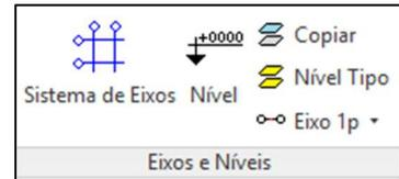
**Sistemas de eixos:** Permite editar os eixos existentes em X e em Y, bem como excluir ou adicionar novos eixos. (Comandos: “CE”).
