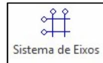
O sistema de eixos do modelo pode ser ajustado a qualquer momento de duas maneiras, a primeira é clicando no menu ribbon no botão sistema de eixos. Irá abrir uma janela onde é possível adicionar, remover renomear ou modificara posição dos eixos, conforme visto no item anterior. Outra maneira é utilizando os comandos do AutoCAD e do CadEM 3D, conforme veremos as seguir.
