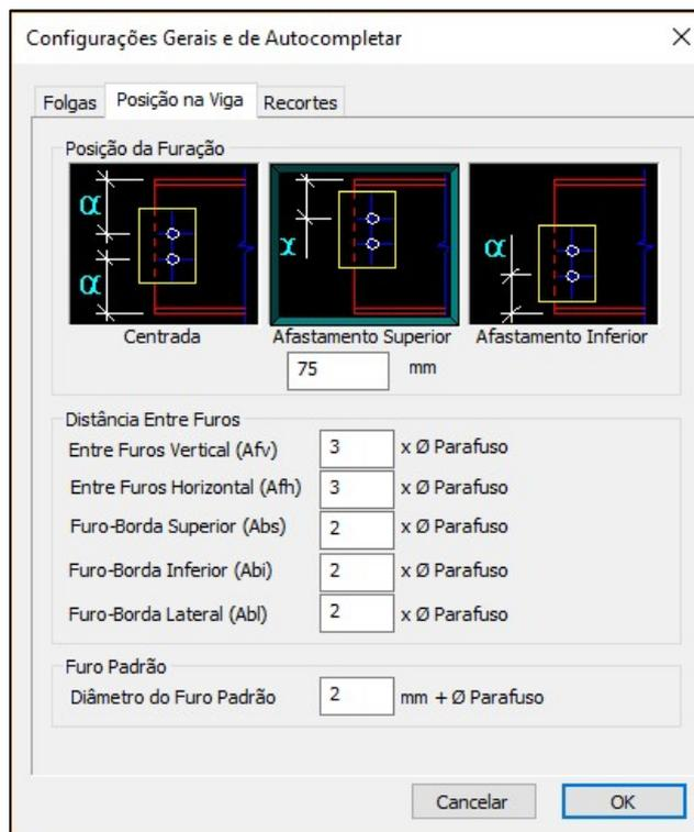
Aba de configuração da posição da ligação na viga e da furação
